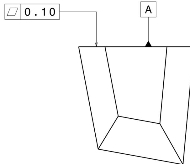
**TOLERANCES** CAD 3D +0 / -0,15 mm
