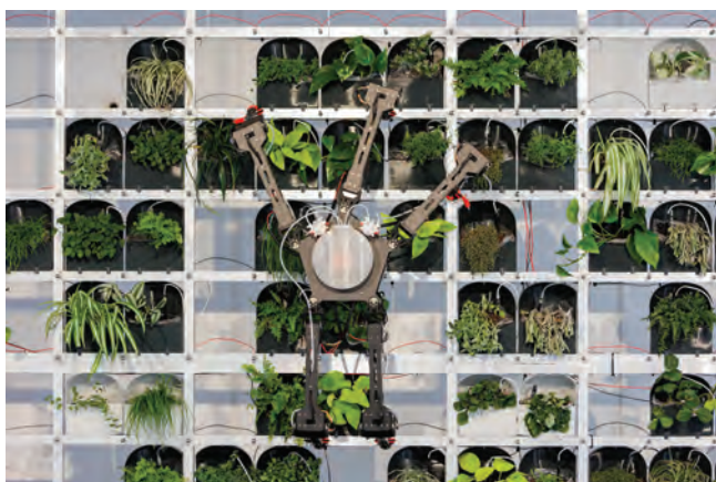
Slika 6: Petnožni plezajoči robot za delo na vrtni
