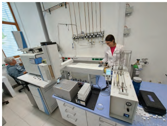
Slika 7: Namestitev DELTA Q IRMS je pomemben napredek pri analizi izotopov, ki združuje izjemno občutljivost, linearnost in stabilnost. Povezan z različnimi perifernimi napravami Thermo Scientific™ je namenjen podpori različnim raziskavam, vključno z metrologijo, znanostjo o hrani, okoljskimi študijami in arheologijo. Poleg obstoječih instrumentalnih zmogljivosti v Sloveniji bo DELTA Q koristil širokemu spektru raziskovalnih in industrijskih partnerjev.
