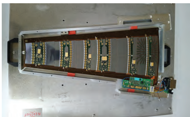
Slika 2: Polno opremljeni del notranjega sledilnika. Senzorski moduli so povezani s fleksibilnim vezjem, ki je bil izdelan v ELGOLINE, d. o. o., iz Podskrajnika. Takšni moduli so gradniki pokrovov novega notranjega sledilnika nabitih delcev v eksperimentu ATLAS.
