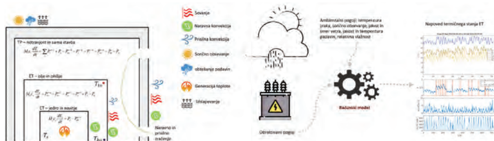
Slika 2: Koncept učinkovite izrabe transformatorjev z uporabo tehnologije DTR (levo) in shema večmasnega fizikalnega modela (desno)
