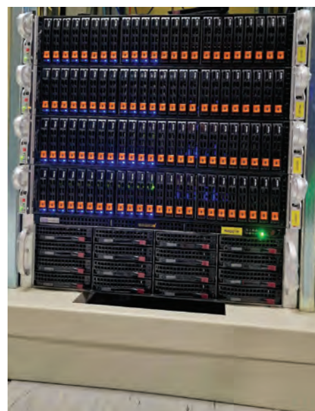
Slika 5: Sistem Proxmox s hitrimi diski v podatkovnem sistemu CEPH zagotavlja varno delovanje virtualnih strojev in vsebnikov.
