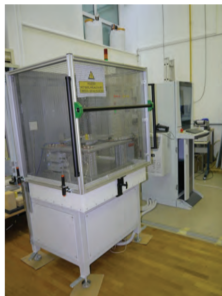
Slika 5: Avtomatski sistem za končno kontrolo kakovosti tip ZKG za podjetje Domel (faza razvoja in izdelave na IJS)
