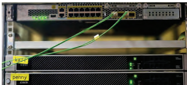
Slika 6: Novi požarni zid instituta ter aktivne naprave za varne omrežne povezave (VPN) nam zagotavljajo hitro in varno povezavo v svet.
