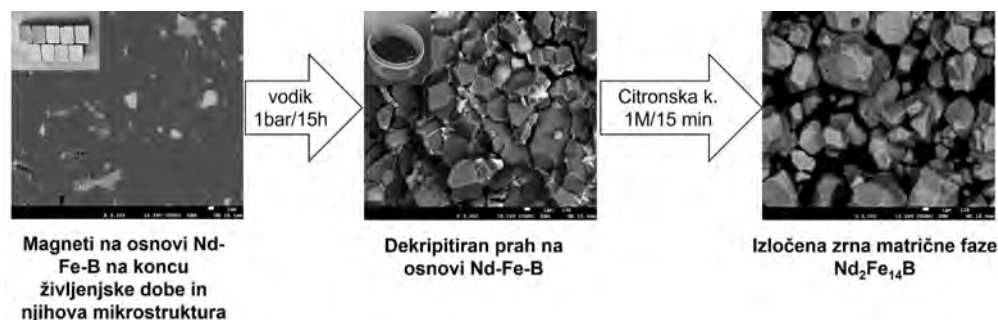
Slika 2: Shematski prikaz novega pristopa selektivnega kemijskega jedkanja, ki vključuje pripravo vhodnega materiala za nove magnetne, ki je monokristalen in temelji zgolj na matrični fazi \text{Nd}_2\text{Fe}_{14}\text{B} , brez prisotnosti medzrnskih faz
