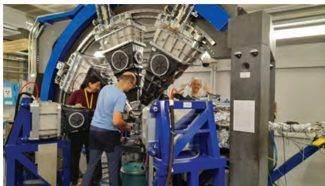
Slika 4: Fotografija eksperimentalne postavitve na žarkovni liniji ID 20 na ESRF v Grenoblu s spektrometrom XRS, ki vsebuje 72 sferičnih analizatorskih kristalov, razporejenih v šest posameznih modulov. Taka konfiguracija zagotavlja analizo sipane rentgenske svetlobe z visoko energijsko ločljivostjo in velikim prostorskim kotom detekcije.
