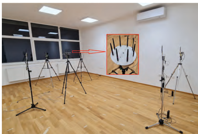
Slika 1: Eksperiment za izračun lokacije in napake iz AoA s komunikacijsko tehnologijo IEEE 802.15.4 TSCH
