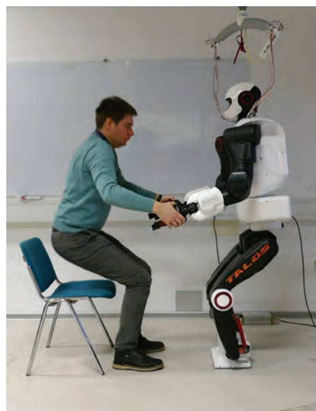
Slika 3: Sodelovanje človeka s humanoidnim robotom, kjer humanoidni robot pomaga človeku pri vstajanju.
