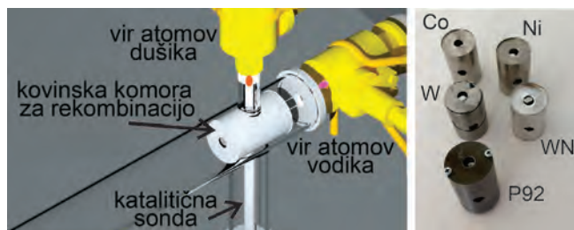
Slika 4: Shema sistema za določitev koeficienta za pretvorbo atomov dušika v amonijak (levo) in reakcijski tulci (desno) (objava 3).
