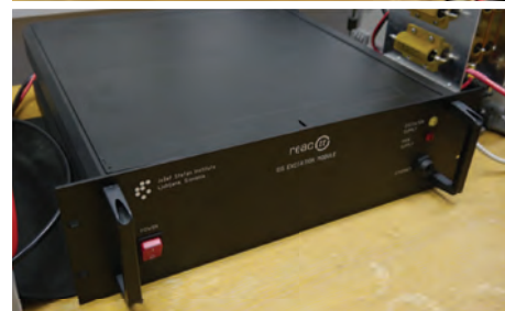
Slika 4: Projekt REACTT – elektronski modul za neinvazivno diagnostiko elektrolizerjev s trdnim elektrolitom (SOEC)
