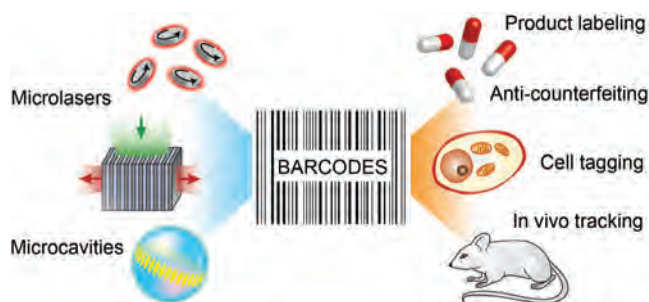
Slika 28: Različni mikrolaserji in mikroresonatorji se lahko uporabljajo kot črtne kode za označevanje izdelkov in spremljanje živih celic.
