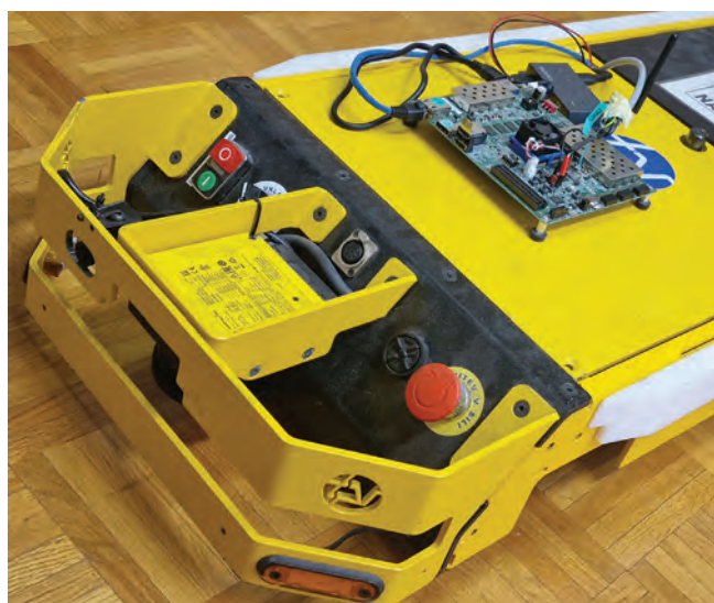
Slika 3: Prototip sistema FPGA za prepoznavanje predmetov pri vozilih AGV.
