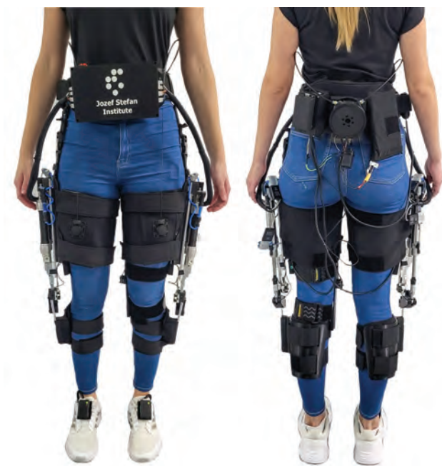
Slika 2: JSI-KneExo, kolenski eksoskelet, ki lahko deluje v aktivnem ali pasivnem načinu.
