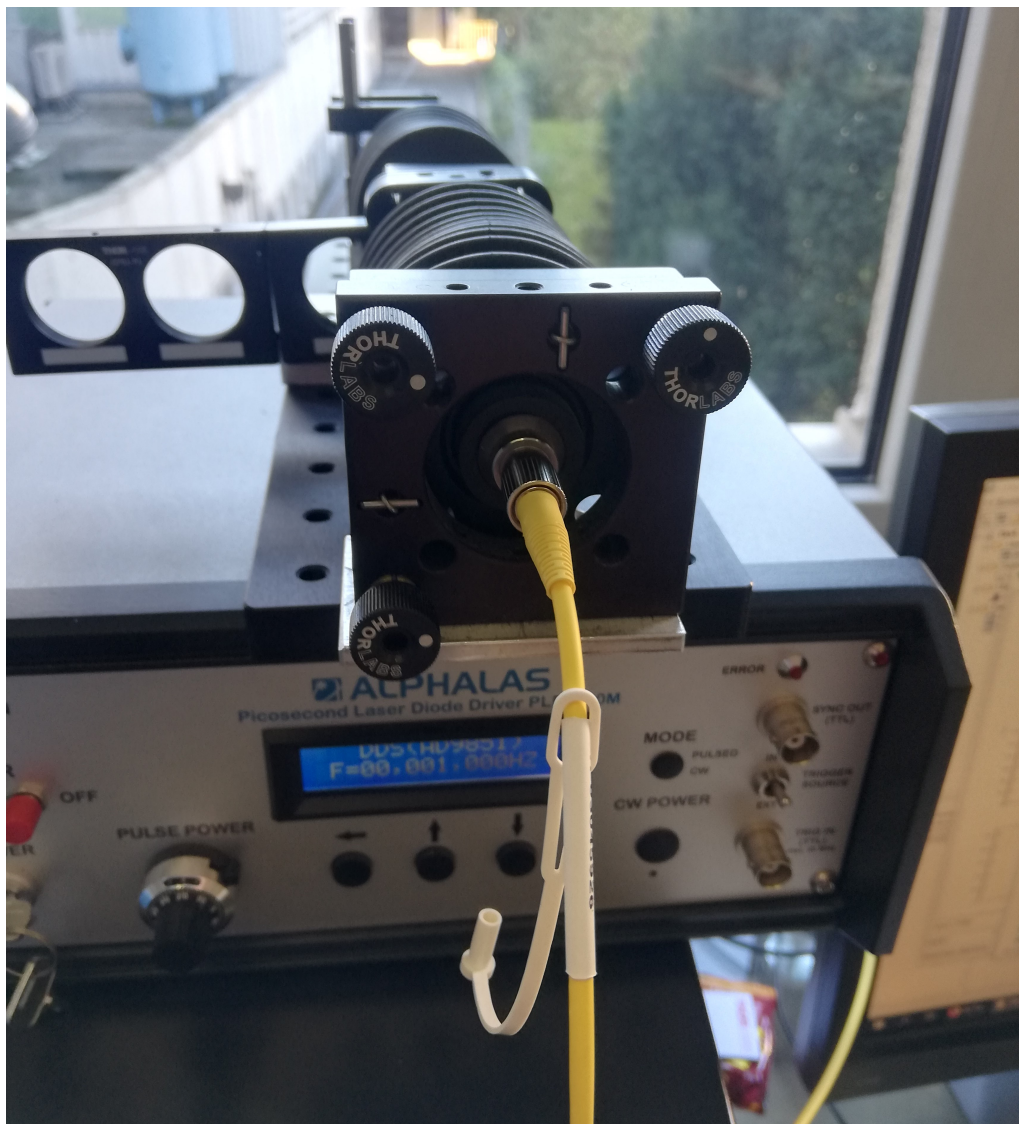
Slika 6.2: Eden od laserjev, ki smo ga uporabljali za meritev IRF. Na levi strani je viden tudi nosilec za optične filtre. Jakost svetlobe, ki doseže detektorja lahko spreminjamo tudi z nagibanjem optičnega vlakna, kjer laser vstopa v vanj.
