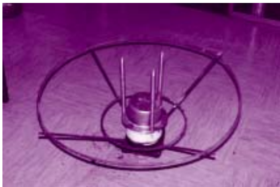
Slika 2: Zaščitno ohišje radioaktivnega vira s konicami strelovoda, obročema in izolatorjem
