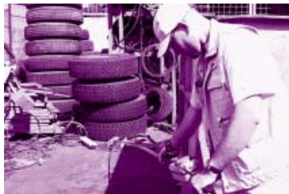
Slika 1: Merjenje sevanja na odpadu v Pivki. Teleskopski merilnik delavcu omogoča merjenje na varni razdalji od vira.
