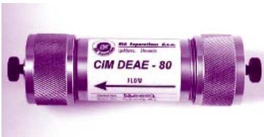
Slika 3: Monolitna kolona CIM 80ml. Kolona ima kapaciteto do 2 g proteina.
